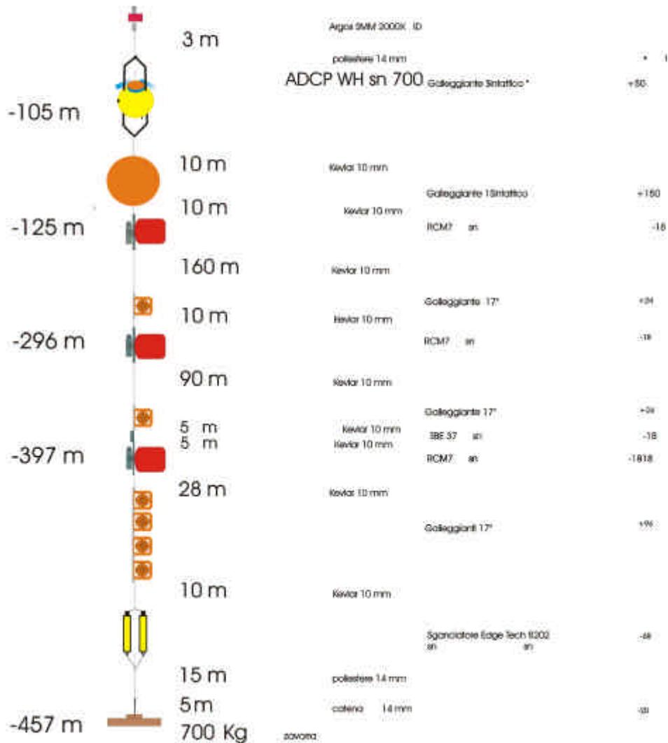
Figura 6.3.2.2. Schema della catena correntometrica C01 ancorata nello Stretto di Sicilia, lato Sicilia
