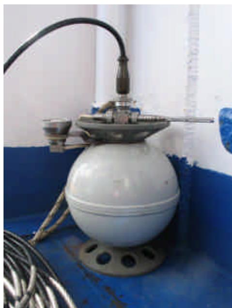
reazione in stato chiuso. Il sondaggio misura l'intensità massima di fluorescenza ( $F_m$ ). Così, in ogni ciclo di misurazione vengono determinati i valori di  $F_0$  e  $F_m$ . L'efficienza della ripartizione dimensionale è direttamente proporzionale alla frazione dei centri di reazione aperti) (Nardello et al.1999). Dal valore di  $F_m$ , determiniamo la concentrazione della biomassa fitoplanctonica. Dal rapporto  $(F_m-F_0)/F_m$  otteniamo la massima resa quantica.
