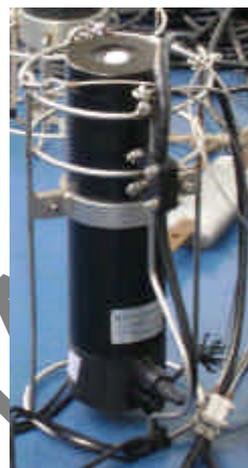
Il PUV-510B permette misure sia della PAR superficiale (SPAR) sia di quella subacquea lungo la colonna d'acqua (UW\_PAR) fino alla profondità di 100 m. Il profilatore è dotato di due subunità, la prima è composta da un sensore PAR-UVA e B che posto sul ponte della nave esegue misure della quantità della luce incidente alla superficie del mare; l'altra subacquea è provvista di un analogo sensore PAR-UVA e B oltre ad uno per la temperatura, pressione e di un fluorimetro naturale.
