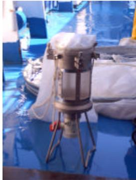
cui è costituita la parte pescante ha vuoto di maglia da 335  $\mu$ m, mentre il bicchiere in cui si raccoglie il campione ha una rete con maglia da 200  $\mu$ m. Al centro della bocca del retino è stato montato un flussimetro per il calcolo dei metri cubi di acqua filtrata. Le pesche effettuate sono state di tipo verticale dai 200 m circa alla superficie. Il campione raccolto (circa 2 l) è stato diviso in due aliquote, metà è stato conservato
